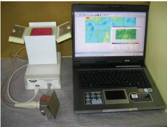
Şəkil 2.9. Distansion termoqraf
